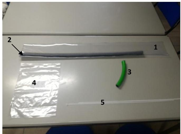
Photo 1 : éléments principaux du piège à chenilles
